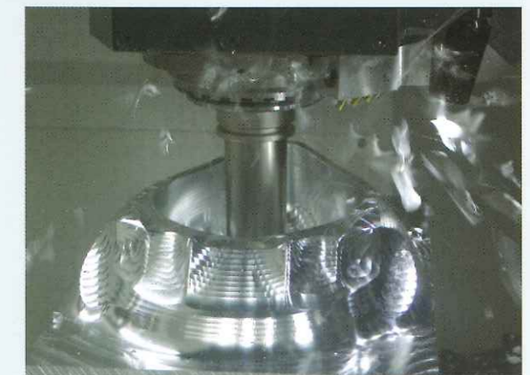
用高效率與中間步距的概念，進行粗加工後，就會產生3D雛型，殘料均勻而更利於後續的加工工序
